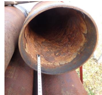
Glødeskal falder af som rustflager
